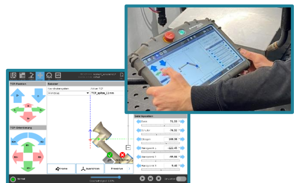
Feinjustierung: Pfeiltasten am Bedienpanel
