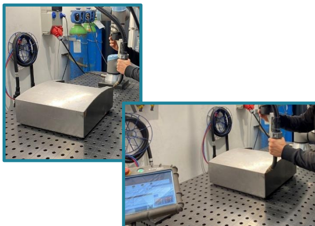
Grobjustierung mittels Free-Drive
