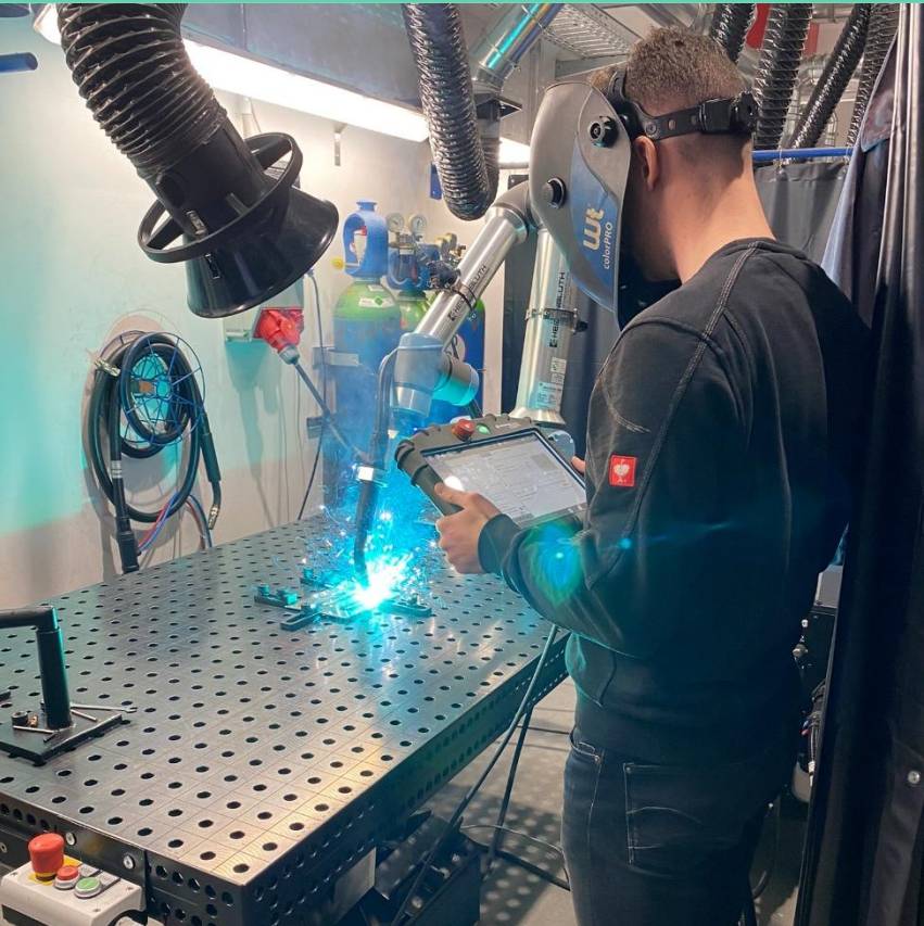
Automatisiertes Schweißen mit einem kollaborierenden Roboter
