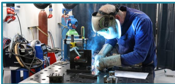
Vorrichtungsbau durch Handschweißer
