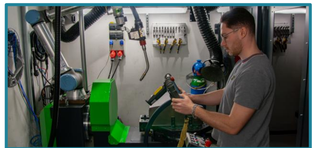
Einrichter/Programmierer beim Teachen der Schweißbahnen
