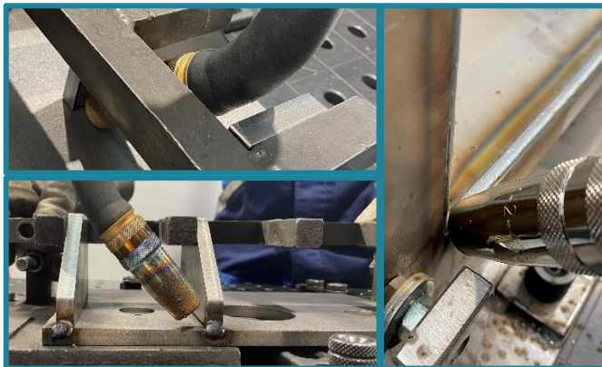
Eingeschränkte Zugänglichkeit zur Schweißnaht verschlechtern die Schweißergebnisse
